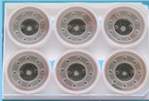
(d) Membrane disposition in Biopress plate
